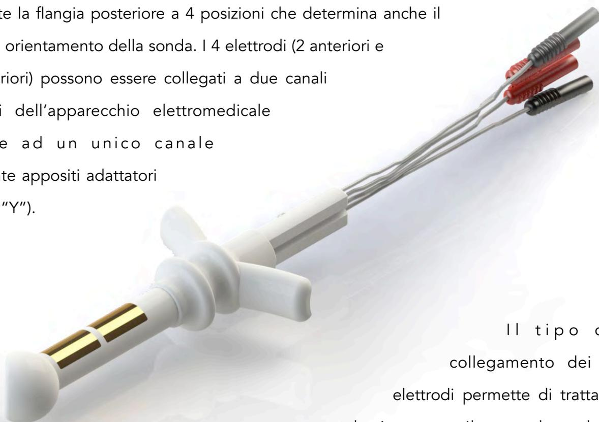
Il tipo di collegamento dei 4 elettrodi permette di trattare selettivamente il muscolo pubo-rettale e lo sfintere anale interno. L'estremità della sonda, destinata a superare lo sfintere anale per essere inserita nell'ampolla rettale, ha una forma sferoidale opportunamente appiattita per limitare l'interferenza con una prostata di volume aumentato, nel trattamento del paziente maschio con ipertrofia prostatica benigna.
