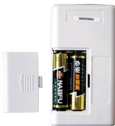
Figura 4. Installazione delle batterie
