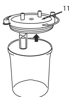
1. Отсоедините защитное устройство (10) от крышки емкости (11)
