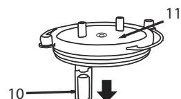
2. Extraiga el flotador (10a) del dispositivo de protección (10).
