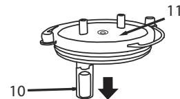
2. Wyjąć cylinder hydrauliczny (.10a) z urządzenia zabezpieczającego (.10)
