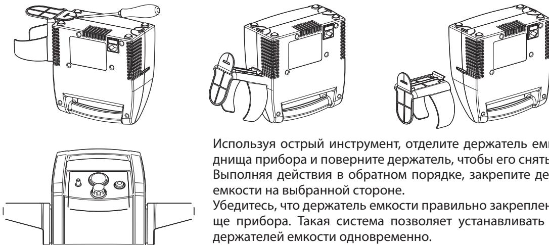
Используя острый инструмент, отделите держатель емкости от днища прибора и поверните держатель, чтобы его снять. Выполняя действия в обратном порядке, закрепите держатель емкости на выбранной стороне. Убедитесь, что держатель емкости правильно закреплен на днище прибора. Такая система позволяет устанавливать до двух держателей емкости одновременно.
