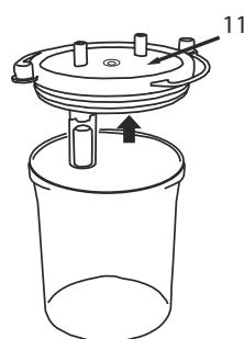
1. Desmonte el dispositivo de protección (10) del tapón de cierre del vaso (11).
