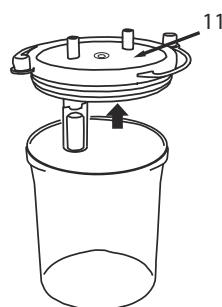
1. Odinstalować urządzenie zabezpieczające (.10) od pokrywy zamkającej pojemnika (.11)
