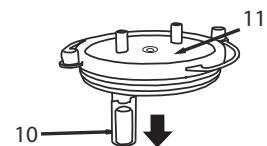
2. Retirer le flotteur (.10a) du dispositif de protection (.10)
