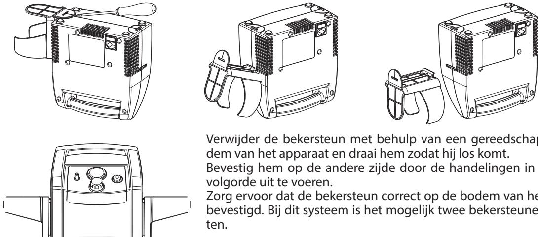
Verwijder de bekersteun met behulp van een gereedschap van de bodem van het apparaat en draai hem zodat hij los komt.
