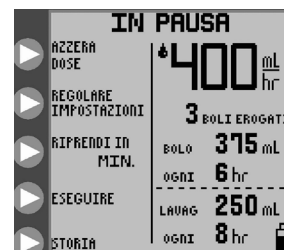
Figura 18B. Opzioni della modalità IN PAUSA , modalità di infusione intermittente.
