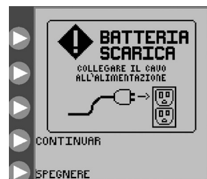
Figura 32. Schermata di errore BATTERIA SCARICA. Indica che la batteria deve essere ricaricata immediatamente.
