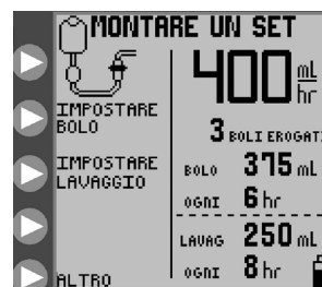
Figura 5B. schermata del menu MONTARE UN SET per la MODALITÀ di infusione intermittente (Modalità EZ non attivata).
