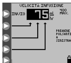
Figura 11B. Impostazione della velocità di infusione.
