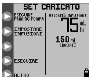
Figura 7A. Menu per la modalità di infusione continua con un set di sola alimentazione.
