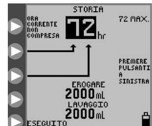
Figura 20. STORIA delle ultime 72 ore dei valori totali di alimentazione e lavaggio, esclusi i dati dell'ora in corso.
