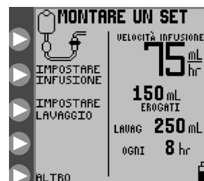
Figura 5A. Schermata del menu MONTARE UN SET per la MODALITÀ di infusione continua (Modalità EZ non attivata).
