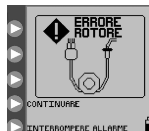
Figura 27. Schermata Errore rotore. Ricaricare il set di tubi e premere CONTINUARE.
