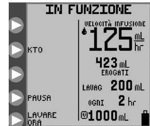
Figura 15A. Schermata della modalità IN FUNZIONE per la modalità di infusione continua.
