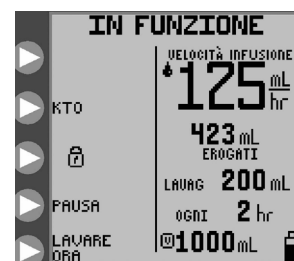
Figura 17. Il lucchetto chiuso indica che la pompa è in modalità BLOCCO DELLO SCHERMO.
