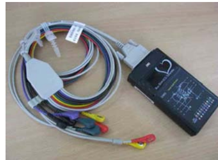
Figura 1.4.2-6. Collegamento del cavo paziente al trasmettitore bluetooth
