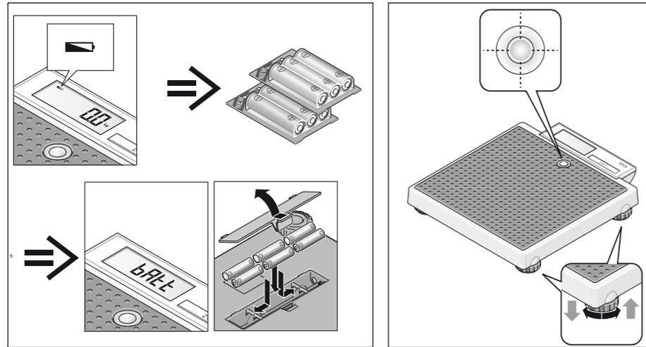
Wiegen • Weighing • Peser • Pesatura • Pesar • Vejning • Vägning • Veiging • Wiegen • Wegen • Pesar • Εύκολη ζύγιση
