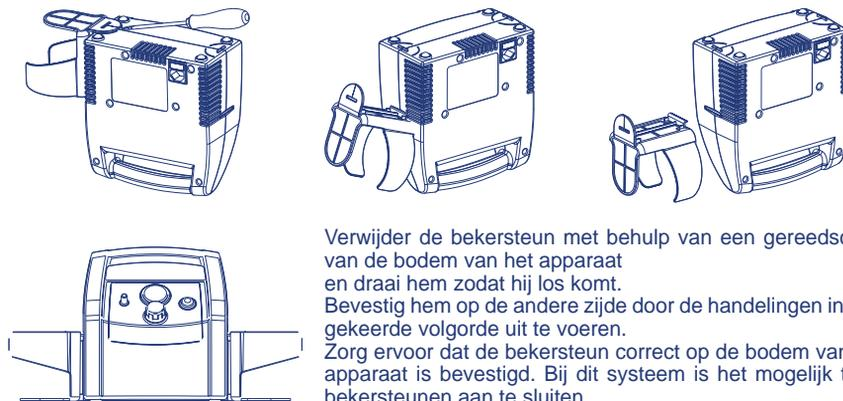
Verwijder de bekersteun met behulp van een gereedschap van de bodem van het apparaat en draai hem zodat hij los komt. Bevestig hem op de andere zijde door de handelingen in omgekeerde volgorde uit te voeren. Zorg ervoor dat de bekersteun correct op de bodem van het apparaat is bevestigd. Bij dit systeem is het mogelijk twee bekersteunen aan te sluiten.
