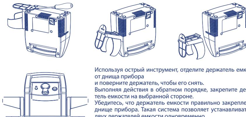
Используя острый инструмент, отделите держатель емкости от днища прибора и поверните держатель, чтобы его снять. Выполняя действия в обратном порядке, закрепите держатель емкости на выбранной стороне. Убедитесь, что держатель емкости правильно закреплен на днище прибора. Такая система позволяет устанавливать до двух держателей емкости одновременно.
