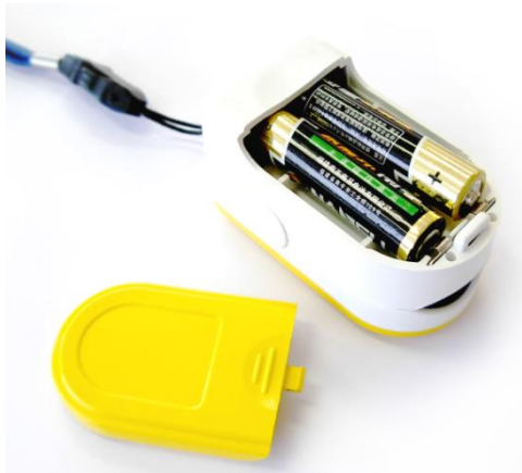
Bild 3 Montage der Batterie
