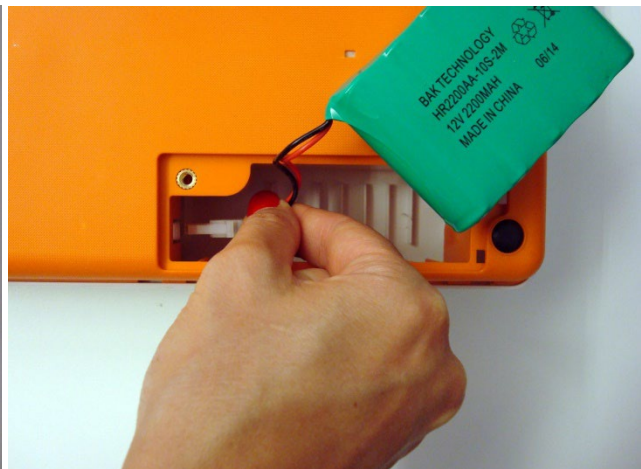
2. Scollegare il connettore batteria.
