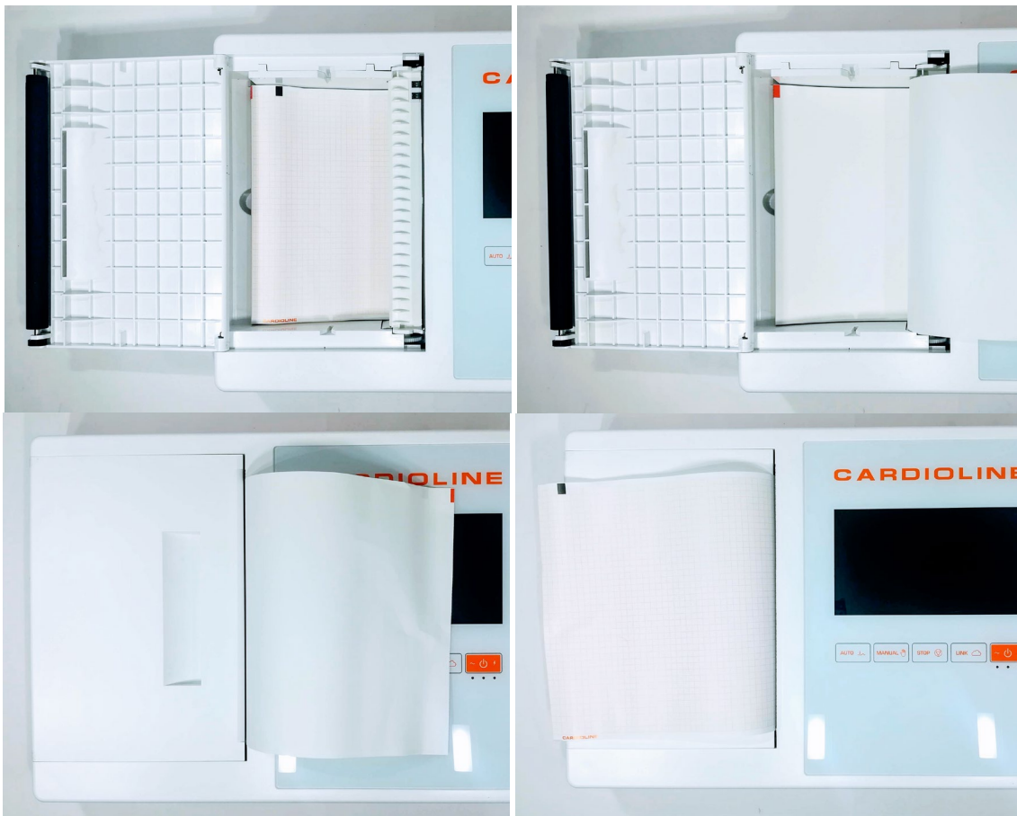
Sequenza per il caricamento della carta
