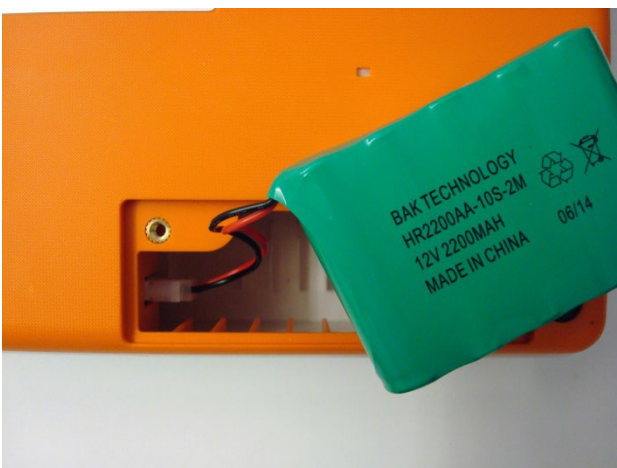
3. Collegare la nuova batteria.
