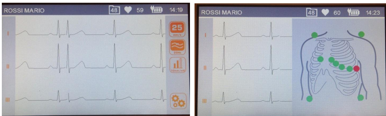
Displej se zobrazením v reálném čase s obrazovkou Torso
