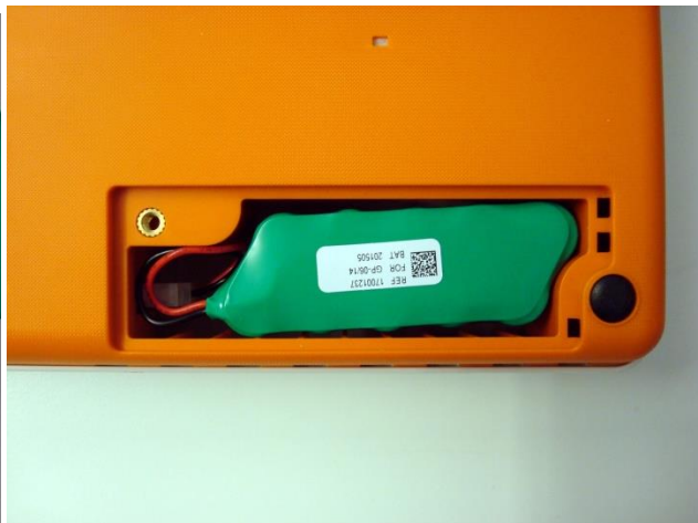
4. Așezați bateria în compartiment.
