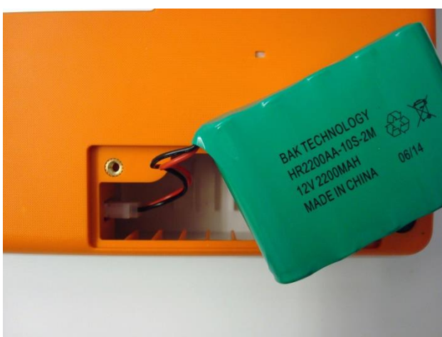
3. Zainstalować nowy akumulator
