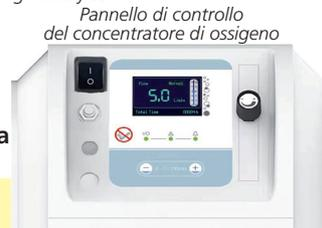
Pannello di controllo del concentratore di ossigeno
