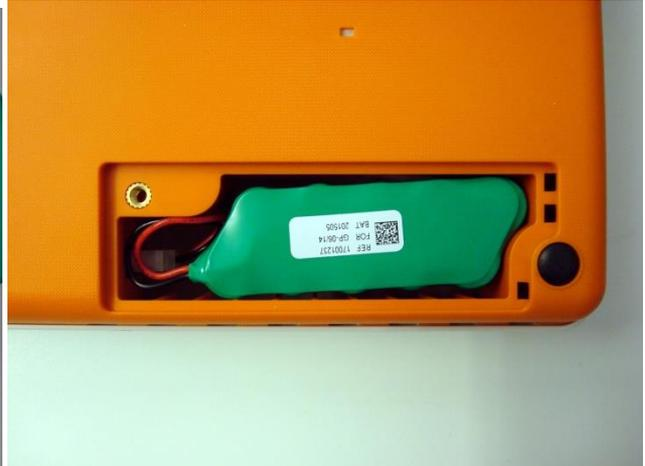
4. Posizionare la batteria nell'alloggiamento.
