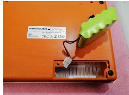
4. Lasciare l'apparecchio con la batteria scollegata per 60 minuti (tempo necessario per resettare la memoria di calibrazione touchscreen).
