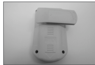
Figura 3-1 Ruotare il gancio per cintura
