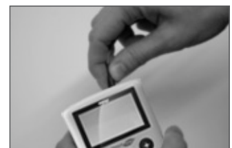
Figura 3-6 Collegare il filo conduttore dell'elettrodo all'unità
