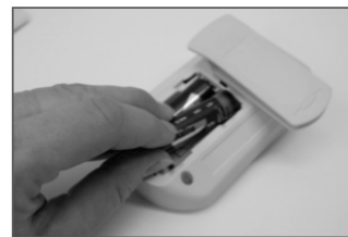
Figura 3-3 Inserire le batterie
