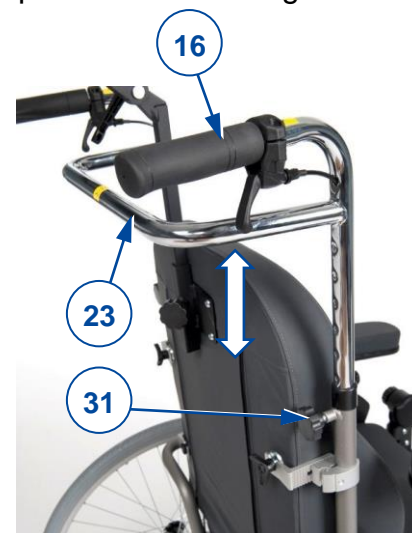
Figura 9 Regolazione dell'altezza delle maniglie di spinta
