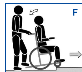
Figura 14 Affrontare i cordoli bassi con un assistente
