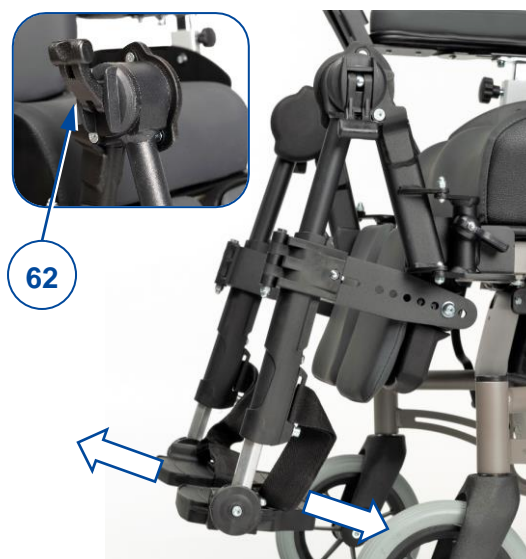
Figura 10 Regolazione dell'angolazione dei poggiapiedi
