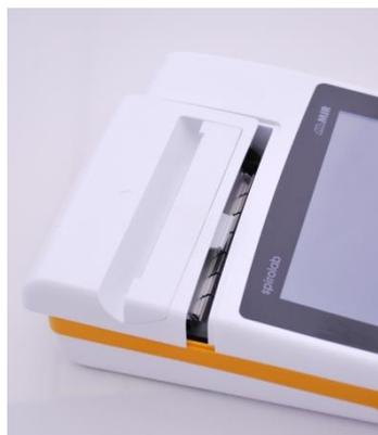
1) Aprire lo sportello per l'alloggiamento della carta termica e rimuoverlo completamente dal dispositivo. Rimuove quindi il supporto per la carta termica.
