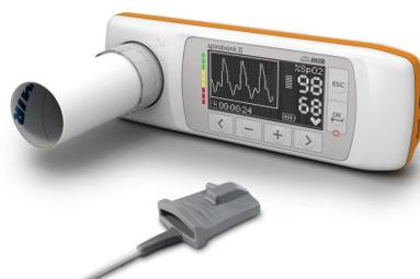
Lo strumento è destinato alla misura dei parametri respiratori ed al monitoraggio della saturazione di ossigeno e della pulsazione cardiaca. Lo strumento effettua un test di controllo sulla qualità dei valori restituiti ed ha internamente una capacità di memoria sufficiente per circa 10000 test spirometrici o al massimo 900 ore di ossimetria.
