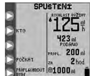
Obrázek 15A. Obrazovka režimu V PROVOZU v režimu nepřetržitého podávání výživy.
