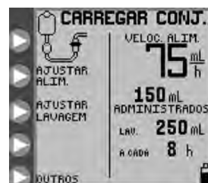
Figura 5A. CARREGAR CONJUNTO ecrã de menu de abertura para o modo de alimentação contínua (Modo Bomba EZ não ativado).
