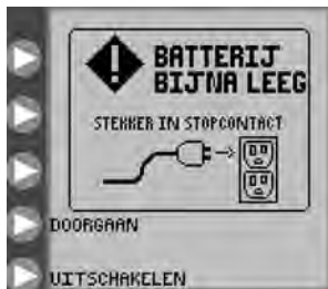
Afbeelding 31. Scherm Batterij bijna leeg. Geeft aan dat de accu inmiddellijk moet worden opgeladen.
