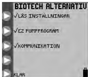
Figur 22. BioTech-alternativskärmen, med låsinställningar, EZ-PUMPPROGRAM, och kommunikationsfunktionerna aktiverade. (Kommunikationsläget är endast för servicetekniker)
