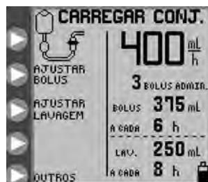
Figura 5B. CARREGAR UM CONJUNTO ecrã de menu de abertura para o modo de administração intermitente (Modo de Bomba EZ não ativado).
