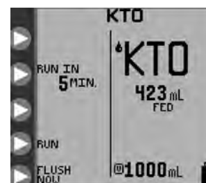
Рисунок 15В. Функция КТО (Держать трубку открытой)
