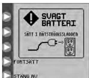
Figur 31. Felskärmen Låg batterinivå. Anger att batterierna måste laddas om direkt.
