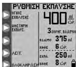
Εικόνα 14A. Μενού ΡΥΘΜΙΣΗ ΕΚΠΛΥΣΗΣ διαλείπουσα λειτουργία.
