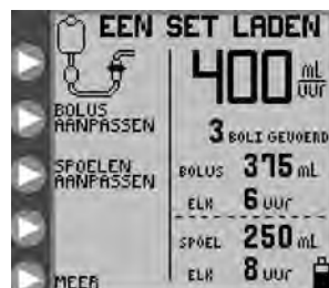
Afbeelding 5B. Scherm van het openingsmenu EEN SET LADEN voor de modus Intermitterende voeding (EZ-pompmodus niet ingeschakeld).
