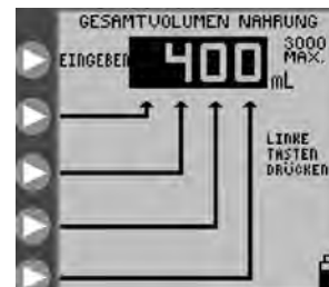
Abbildung 11C: Einstellung des zu verabreichenden Nahrungszufuhrvolumens
