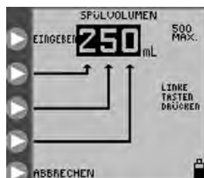
Abbildung 14B: Einstellung des Spülvolumens
