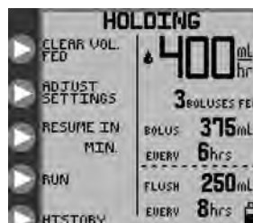
Rysunek 18B. Opcje trybu HOLDING (WSTRZYMANIE), przerywany tryb żywienia.
