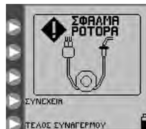
Εικόνα 26. Οθόνη σφάλματος ρότορα. Επαναφορτώστε τη σωλήνωση του σετ και πατήστε ΣΥΝΕΧΕΙΑ .
