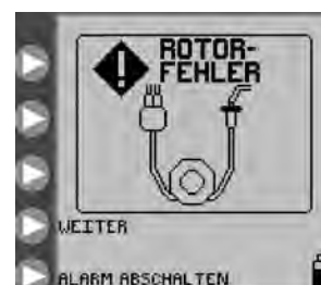
Abbildung 26: Rotorfehler-Bildschirm. Die Leitung des Sets neu verlegen und WEITER drücken.
