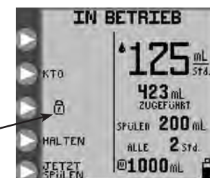
Abbildung 17: Das Vorhängeschloss gibt an, dass sich die Pumpe im Zustand BILDSCHIRM SPERREN befindet.
