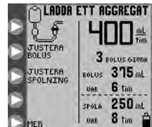
Figur 5B. LADDA ETT AGGREGAT, öppningsmeny för intermitternt matning (EZ-pumpprogram inte aktiverat).
