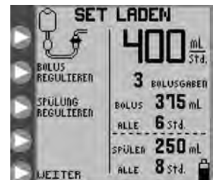
Abbildung 5B: Ausgangsmenü-Bildschirm SET LADEN für die Nahrungszufuhr im Intervallbetrieb (EZ PUMPEN MODUS nicht aktiviert)
