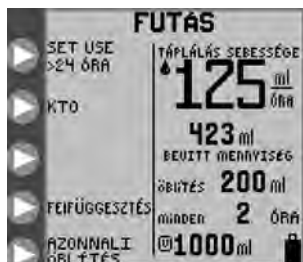
33. ábra “Futás” képernyő 24 órán túl használt szerelék esetén. A használat jelzője a képernyő bal felső részén található.
