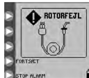
Figur 26. Skærm for rotorfejl. Påsæt slangen igen, og tryk på FORTSÆT .
