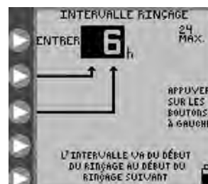
Figure 14C. Réglage de l'intervalle entre les rinçages.
