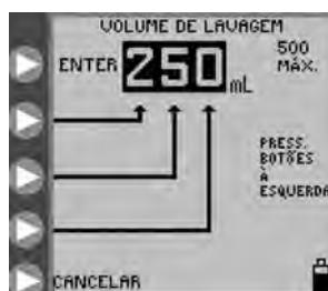
Figura 12B. Definição do volume de enxaguamento.
