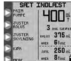
Figur 7D. Startmenu for intermitterende ernæringstilstand med et sæt til ernæring og skylning.
