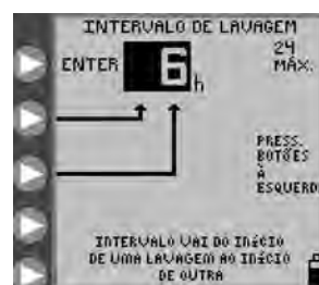
Figura 12C. Definição do intervalo de tempo de Lavagem .
