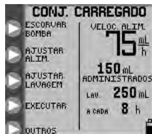
Figura 7B. Menu de abertura para modo de alimentação contínuo com conjuntos de bomba de alimentação e exaustão
