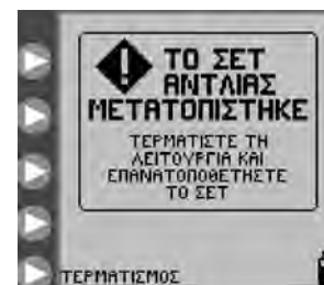
Εικόνα 30. Οθόνη σφάλματος μετατόπισης του σετ αντλίας.
