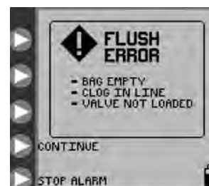
Rysunek 28. Okno błędu płukania.
