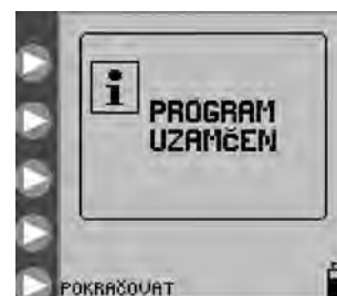
Obrázek 16. Obrazovka Program uzamčen, která znamená, že pumpa je v režimu NASTAVENÍ ZÁMKU.
