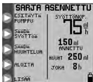
Kuva 7B. Avausvalikko, jatkuva ruokintatila, ruokinta- ja huuhtelusarja
