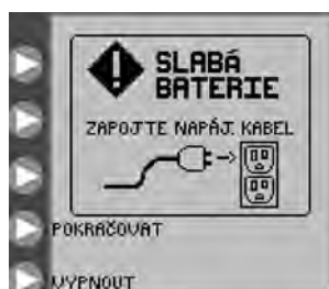
Obrázek 31. Obrazovka chyby Slabá baterie. Znamená, že je třeba neprodleně znovu nabít baterii.
