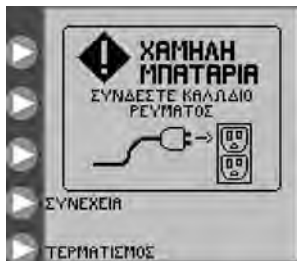
Εικόνα 31. Οθόνη σφάλματος Χαμηλής μπαταρίας. Υποδεικνύει πως πρέπει να επαναφορτιστεί άμεσα η μπαταρία.
