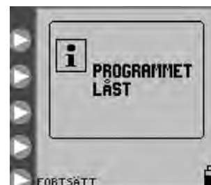
Figur 16. Skärmen Program låst som anger att pumpen är i läget LÅSINSTÄLLNINGAR .
