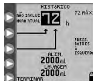
Figura 20. Totais de alimentação e enxaguamento para até 72 horas de histórico anterior, excluindo os dados da hora atual.
