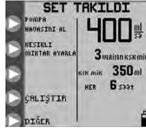
Şekil 7C. Sadece Besleme setiyle Aralıklı Besleme modu için açılış menüsü.
