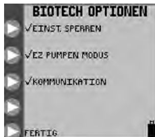
Abbildung 22: Bildschirm „Biotech Optionen“ mit den aktivierten Funktionen EINST. SPERREN , EZ PUMPEN MODUS und KOMMUNIKATION (Kommunikationsmodus nur für Service-Mitarbeiter)
