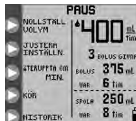
Figur 18B. Läget PAUS alternativ, intermittent matningsläge
