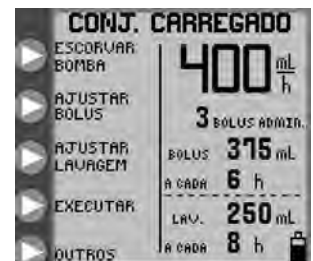
Figura 7D. Menu de abertura para modo de alimentação intermitente com conjuntos de bomba de alimentação e exaustão
