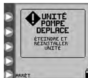
Figure 30. Écran Erreur Dispositif de pompe délogé.
