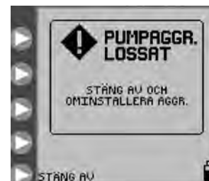
Figur 30. Skärmen Fel – Pumpaggregatet Lossat.
