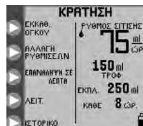
Εικόνα 18Α. Επιλογές λειτουργίας ΚΡΑΤΗΣΗ, λειτουργία συνεχούς σίτισης.
