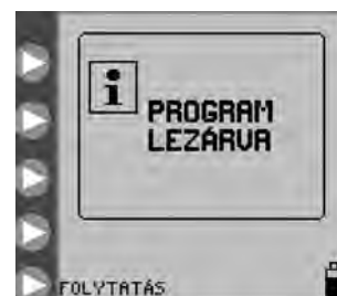
16. ábra „Program Zárva” épernyő, mely jelzi, hogy a pompa „BEÁLLÍTÁSOK ZÁROLÁSA” üzemmódban van
