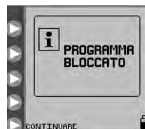
Figura 16. Schermata Programma bloccato, che indica che la pompa è in modalità di BLOCCO DELLE IMPOSTAZIONI .
