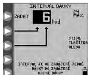
Obrázek 13E. Nastavení časového intervalu mezi spuštění bolusu.
