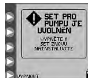
Obrázek 30. Obrazovka Chyby vysunutí soupravy pumpy.
