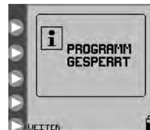
Abbildung 16: Der Bildschirm „Programm gesperrt“ gibt an, dass sich die Pumpe im Zustand EINST. GESPERRT befindet.
