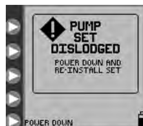
Рисунок 30. Экран ошибки в связи с удалением комплекта насоса
