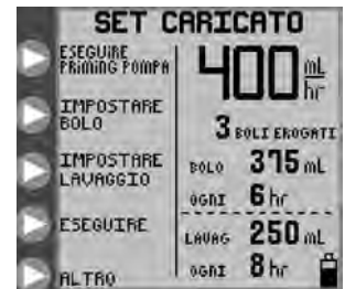
Figura 7D. Menu di apertura per la modalità di infusione intermittente con un set di alimentazione e lavaggio.
