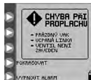
Obrázek 28. Obrazovka Chyba proplachování.
