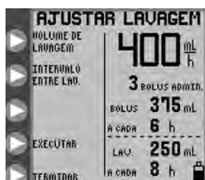
Figura 14A. Menu AJUSTAR ENXAGUAMENTO , modo intermitente.
