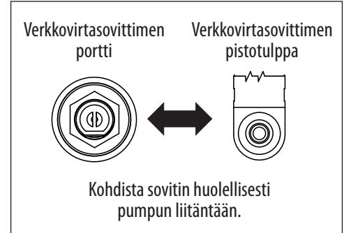
Kuva 2. Verkkovirtasovittimen liittimen ja pumpun sovitinportin kohdistus
