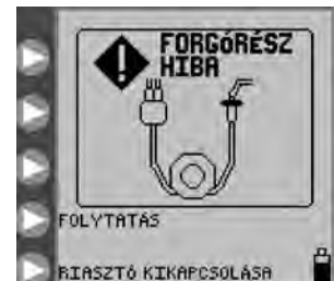
26. ábra: „Forgórész hiba” képernyő Kösse be újra a szerelék csövet és nyomja meg a FOLYTATÁS -t.
