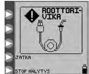
Kuva 26. Roottorivian en näyttö ASENNA SARJAN letkut uudelleen ja paina JATKA.
