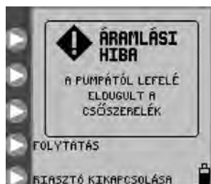
29. ábra: „Áramlási hiba” képernyő
