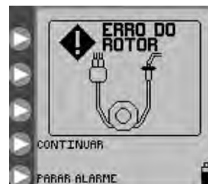
Figura 26. Ecrã de erro de rotor. Recarregue o tubo do conjunto e pressione CONTINUAR.
