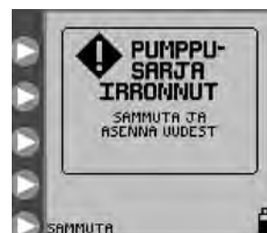
Kuva 30. Pumppusarja irronnut -vikaen näyttö
