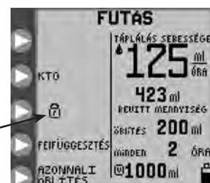
17. ábra A lakat, mely jelzi, hogy a pompa „BEÁLLÍTÁSOK ZÁROLÁSA” üzemmódban van
