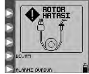
Şekil 26. Rotor Hatası ekranı. Set tüpünü geri yükleyin ve DEVAM'a basın.
