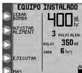
Figura 7C. Menú inicial del modo de alimentación intermitente con un equipo sólo de alimentación.
