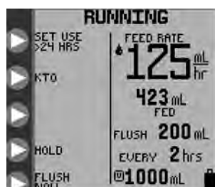
Rysunek 33. Okno w trybie Running (praca w toku) z komunikatem o używaniu zestawu pompy ponad 24 godziny w lewym górnym rogu ekranu.
