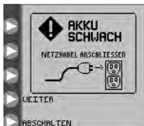
Abbildung 31: Fehlerbildschirm AKKU SCHWACH. Gibt an, dass der Akku sofort aufgeladen werden muss.
