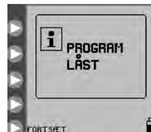
Figur 16. Skærm for program låst, der angiver, at pumpen er i tilstanden LÅSEINDSTILINGER .
