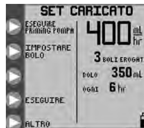
Figura 7C. Menu di apertura per la modalità di infusione intermittente con un set di sola alimentazione.
