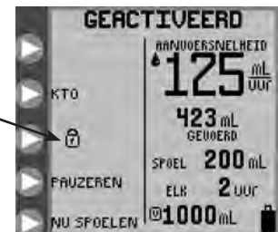
Afbeelding 17. Het slotje geeft aan dat de pomp zich in de modus SCHERM VERGRENDELEN bevindt.
