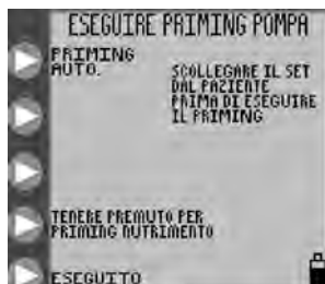
Figura 8A. Menu ESEGUIRE PRIMING POMPA per set di sola alimentazione.
