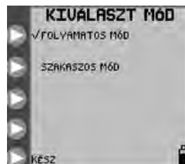
10B ábra: ÜZEMMÓD VÁLASZTÁSA menü folyamatos vagy szakaszos üzemmód választásához.
