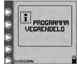
Afbeelding 16. Scherm Programma vergrendeld, wat aangeeft dat de pomp zich in de modus INSTELLINGEN VERGRENDELEN bevindt.
