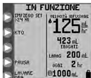
Figure 33. Schermata In funzione con l'indicatore di utilizzo del set pompa > 24 ore nella parte superiore sinistra dello schermo.
