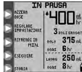
Figura 18B. Opzioni della modalità IN PAUSA , modalità di infusione intermittente.
