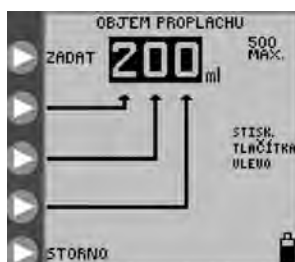
Obrázek 14B. Nastavení objemu proplachování
