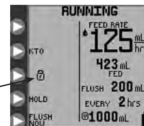
Rysunek 17. Kłódka informuje, że pompa jest w trybie LOCK SCREEN (BLOKADA EKRANU) .
