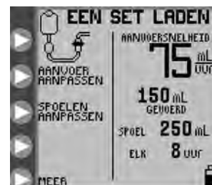
Afbeelding 5A. Scherm van het openingsmenu EEN SET LADEN voor de modus Continuvoeding (EZ-pompmodus niet ingeschakeld).
