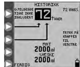
Figur 20. Totalt volum ernæring og skylking for opptil 72 timer med logghistorie, ekskludert data fra den siste timen.
