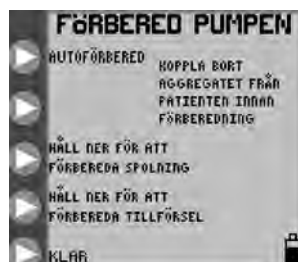
Figur 8B. FÖRBERED PUMPEN-meny för matnings- och spolningsset.
