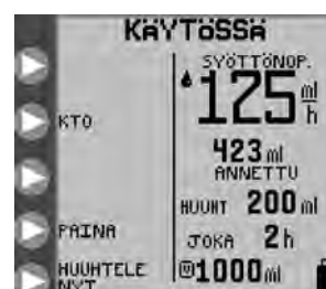
Kuva 15A. KÄYNNISSÄ-tilan näyttö, jatkuva ruokintatila
