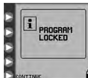
Rysunek 16. Okno Program Locked (zablokowany program) , które informuje, że pompa jest w trybie LOCK SETTINGS (ZABLOKOWANIE USTAWIENI) .
