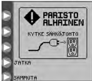
Kuva 31. Paristo Alhainen -näyttö osoittaa, että akku on ladattava välittömästi.
