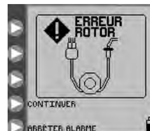
Figure 26. Écran Erreur de rotor. Recharger la tubulure du set et appuyer sur CONTINUER.
