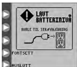
Figur 31. Lavt batterinivå-skjermen. Indikerer at batteriet må lades opp umiddelbart.
