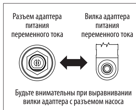
Рисунок 2. Сопоставление вилки адаптера питания переменного тока с портом адаптера насоса
