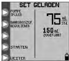
Abbildung 7A: Ausgangsmenü für die Nahrungszufuhr im Dauerbetrieb bei einem ausschließlich für die Ernährung vorgesehenen Set
