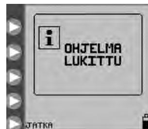
Kuva 16. Ohjelma lukittu -näyttö, joka osoittaa, että pumpun tilana on LUKITSE ASETUKSET
