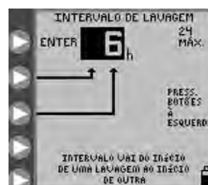
Figura 14C. Definição do intervalo de tempo de enxaguamento.
