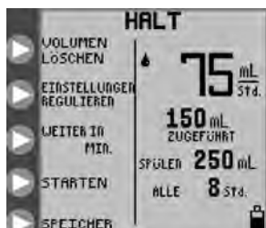
Abbildung 18A: Optionen im Zustand HALT bei Nahrungszufuhr im Dauerbetrieb
