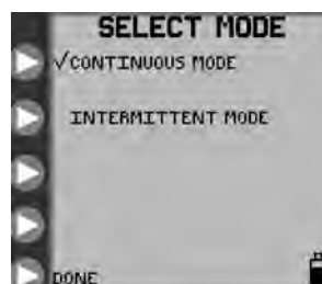
Рисунок 10В. Меню SELECT MODE (ВЫБОР РЕЖИМА) для выбора непрерывного или периодического режима подачи питания
