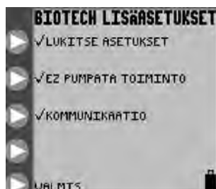
Kuva 22. BioTech-asetukset, LUKITSE ASETUKSET-, EZ-PUMPPUTILA- ja Tiedonsiirto-toiminnot aktivoitu (Tiedonsiirtotila on tarkoitettu vain ammattimaisille huoltoteknikoille.)
