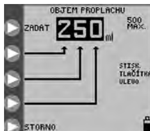
Obrázek 12B. Nastavení objemu proplachování
