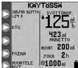
Kuva 33. Käynnissä-näyttö ja pumppu käytössä > 24 tuntia -ilmais in vasemmassa yläkulmassa
