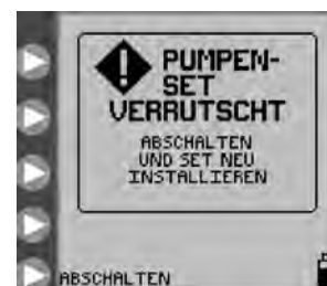
Abbildung 30: Fehlerbildschirm „Pumpenset verrutscht“
