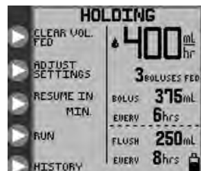
Рисунок 18В. Параметры режима HOLDING (ПАУЗА) , периодический режим подачи питания
