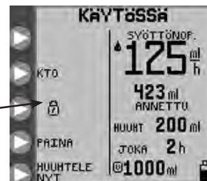
Kuva 17. Lukko osoittaa, että pumppu on NÄYTTÖLUKITUS-tilassa.
