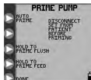
Рисунок 8В. Меню PRIME PUMP (ЗАПОЛНИТЬ НАСОС) для комплекта для подачи питания и промывания
