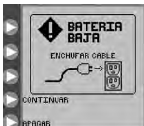
Figura 31. Pantalla de error Bateria baja. Indica que es necesario cargar inmediatamente la batería.
