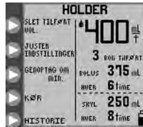
Figur 18B. Valgmuligheder for tilstanden HOLDER , intermitterende ernæringstilstand.
