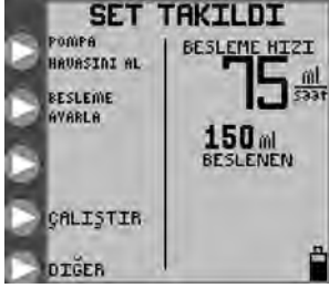
Şekil 7A. Sürekli Besleme setiyle Sürekli Besleme modu için açılış menüsü.
