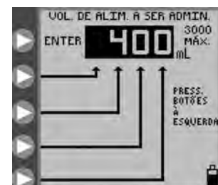
Figura 11C. Definição do volume de alimentação a ser realizado.
