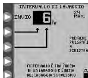
Figura 12C. Impostazione dell'intervallo di tempo del lavaggio.
