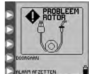
Afbeelding 26. Scherm Probleem rotor. Laad de slangenset opnieuw en druk op DOORGAAN .
