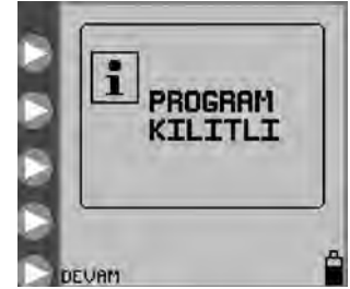
Şekil 16. Pompanın AYARLARI KİLİTLE modunda olduğunu gösteren Program Kilitli ekranı.
