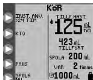
Figur 33. KÖR-skärmen med indikatorn för > 24 h-användning av pumpsetet längst upp till vänster på skärmen.
