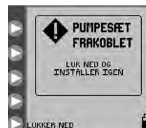
Figur 30. Skærm for fejl ved løsnet pumpesæt.
