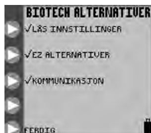
Figur 22. BioTech-alternativskjermen, med funksjonene Lås innstillinger, EZ-PUMPEMODUS og Kommunikasjoner aktivert. (Kommunikasjonsmodus kun for profesjonelle serviceteknikere)
