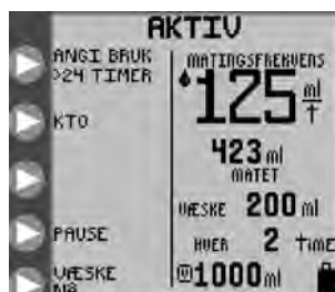
Figur 33. Skjermen AKTIV med indikatoren Pumpesett brukt i > 24 t øverst til venstre på skjermen.
