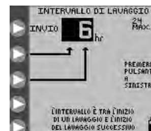
Figura 14C. Impostazione dell'intervallo di tempo del lavaggio.
