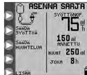
Kuva 5A. ASENNNA SARJA -avausvalikkonäyttö, jatkuva ruokintatila (EZ-pumpputila ei ole aktiivinen)
