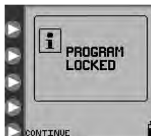
Рисунок 16. Экран «Программа заблокирована», который указывает на то, что насос находится в режиме LOCK SETTINGS (ЗАБЛОКИРОВАТЬ НАСТРОЙКИ)
