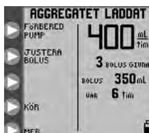
Figur 7C. Öppningsmeny för intermittant matningsläge med ett set för endast matning.
