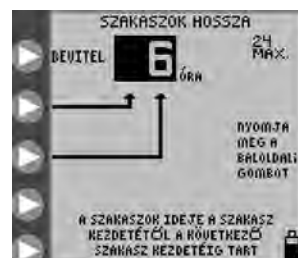
13E ábra: Szakaszok indítása közötti időintervallum beállítása
