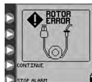
Rysunek 26. Okno błędu wirnika. Ponownie ułożyć przewody zestawu i nacisnąć przycisk CONTINUE (KONTYNUUJ).
