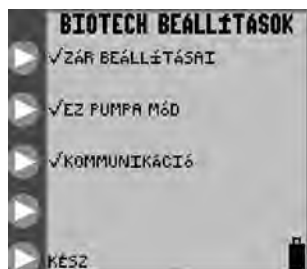
22. ábra BioTech képernyő; „Beállítások zárolása”, „EZ pumpa mód” és „Kommunikáció funkciók” bekapcsolva. (Kommunikációs üzemmód csak szervizes akemberek számára.)
