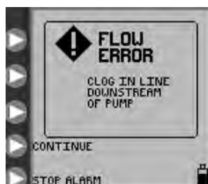
Rysunek 29. Okno błędu przepływu.
