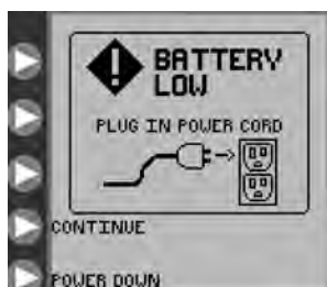
Rysunek 31. Okno błędu rozładowanego akumulatora. Informuje, że akumulator wymaga natychmiastowego naładowania.
